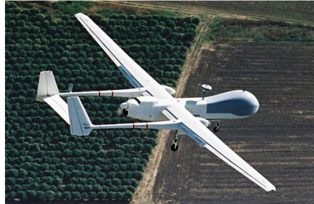
Heron TP em vôo, equipado de 1x PT6A (Pratt & Whitney) de 900 kW (turbohélice)
