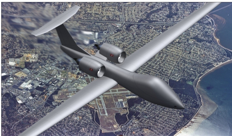
VANT tipo MALE motorizado com 2x ARAM 390
